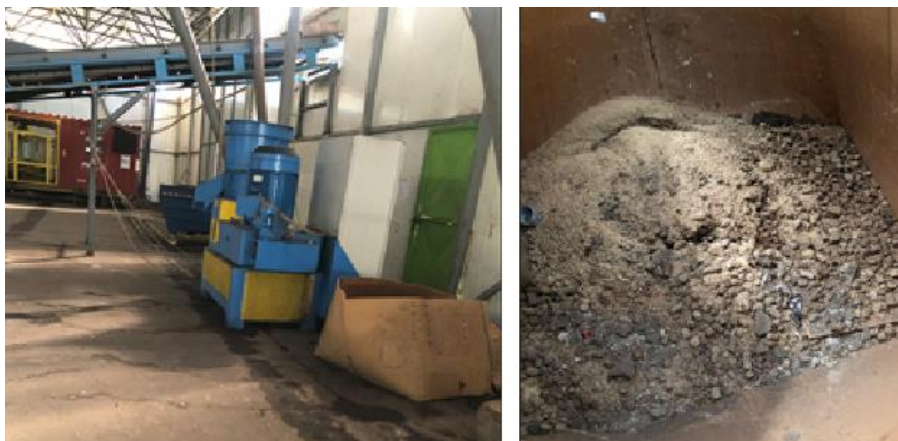
Слика 54 Машина за производство на RDF гориво и произведено RDF гориво Зад машината наменета за производство на РДФ гориво поминува транспортна лента, со која се врши транспорт на отпад надвор од халата и се собира во син контејнер .
