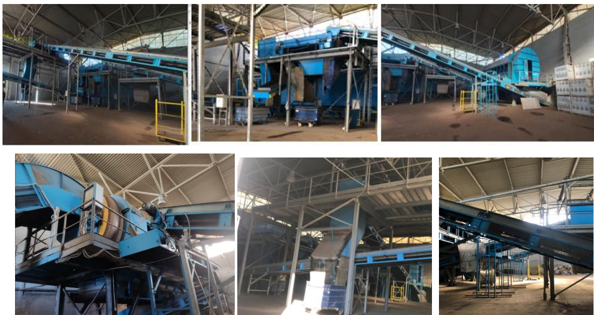
Слика 43 Сепарација на органска/сува фракција, сепарација на метал/неметал
