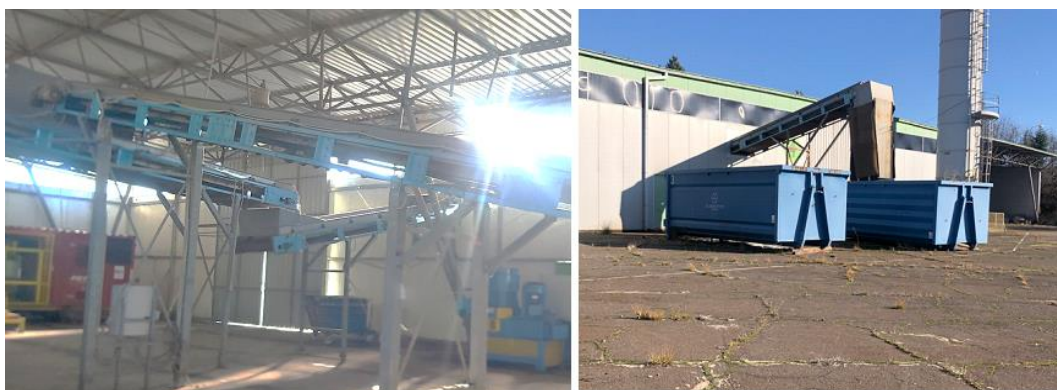
Слика 55 Транспортни ленти и излез од транспортната лента
