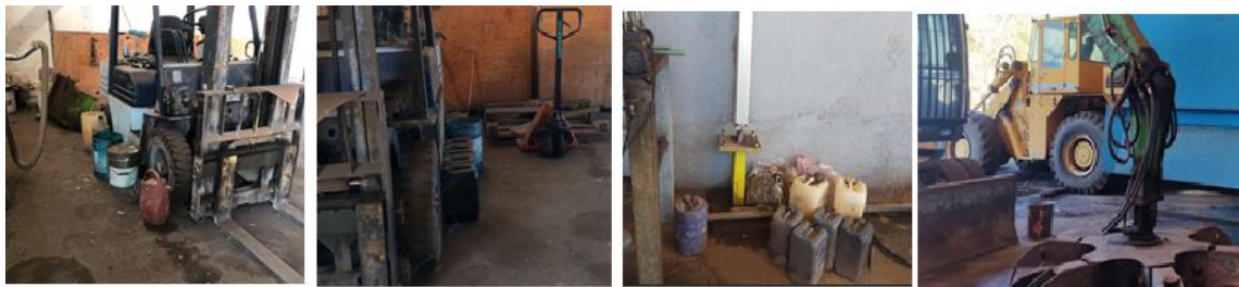
Слика 92 Истекувања, собирни садови и отпадно пакување кое е загадено со опасни материи
